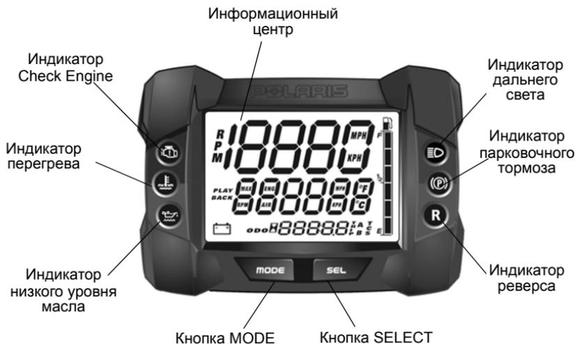
Цифровой прибор содержит индикаторы и информационный центр. Информационный центр можно контролировать с помощью кнопок MODE и SELECT на цифровом приборе или кнопкой MODE/SET на левой рукоятке руля или на консоли.
