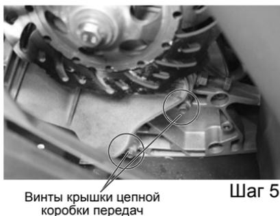
**ПРИМЕЧАНИЕ:** НЕ вставляйте отвертку или монтажку между крышкой и корпусом коробки. В этом случае возможно повреждение прокладки.
