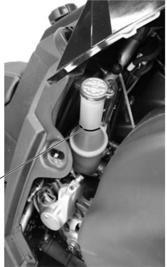
**ПРИМЕЧАНИЕ:** Эксплуатация снегохода с неисправной системой охлаждения может привести к перегреву и серьезной поломке двигателя. Обязательно поддерживайте рекомендуемый уровень охлаждающей жидкости.
