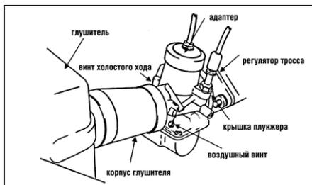
3. Ослабляя контргайку крепящую адаптер троса газа; затем вращайте адаптер троса по часовой стрелке, пока основание не окажется в отверстии клапана плунжера
