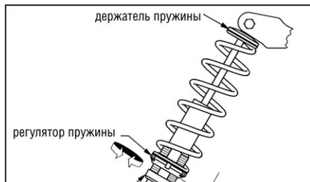
**ПРИМЕЧАНИЕ:** регулятор натяжения пружины будет вращаться вместе с пружиной.
