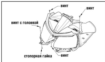
5. Закрутите винты, расположенные снаружи регуляторов передних фар; затем надежно затяните их.
