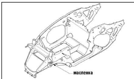
На моделях Bearcat/F-Series/Z1/T-Series/TZ1 поверните руль вправо; затем с правой стороны, а потом с левой стороны добавьте смазку в рычаг управления, пока смазка не начнет вылезать из под обоих концов рычага управления. Удалите излишек смазки.
