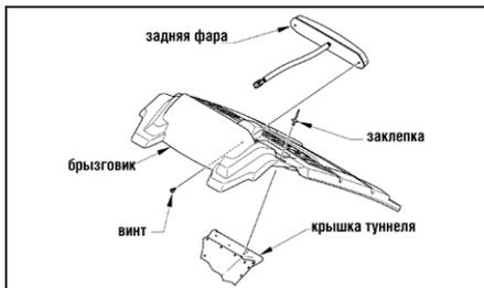
3. Снимите два винта, крепящих заднюю фару к брызговику.
