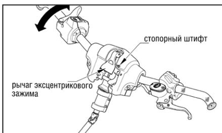
2. Отрегулируйте наклон руля; затем надежно затяните винты с моментом 3,5 кг/метр; проверьте максимальный выворот руля влево и вправо.
