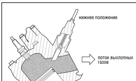
Это обеспечивает низкое положение выпускных портов и максимальную мощность при низких оборотах, а также экономию топлива.
