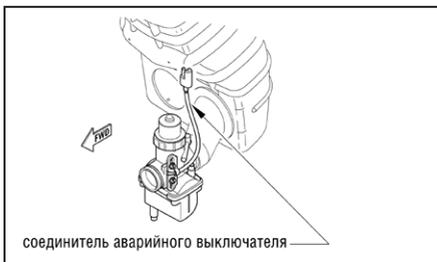
**ПРИМЕЧАНИЕ:** на моделях с жидкостным охлаждением, если рычаг газа работает нормально, а двигатель не заводится, то проблемой может быть неисправный выключатель дросселя. Отвезите Ваш снегоход к официальному дилеру Arctic Cat для проведения
