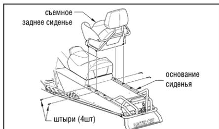
2. Поднимите заднюю часть сиденья и потяните его назад для того, чтобы снять с основания.
