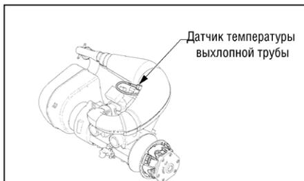
**ПРИМЕЧАНИЕ:** выведенная из строя система (ЕСТ) НЕ ВЫЗОВЕТ поломку двигателя; однако, неисправная система ЕСТ придаст более медленную приемистость и может выдавать несколько худшие максимально-конечные параметры.
