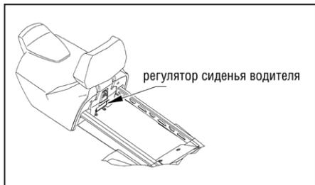
3. Поднимите заднюю часть сиденья; затем подвиньте переднюю часть сиденья вверх или вниз (всего семь возможных положений).
