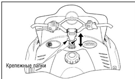
2. При нажатых крепежных лапках отрегулируйте руль до желаемого положения, затем отпустите крепежные лапки – это закрепит руль в новом положении.
