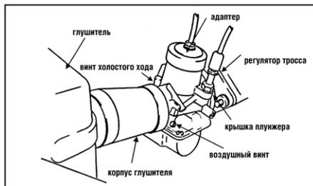
3. Медленно поверните регулятор троса против часовой стрелки, одновременно проверяя свободный ход рычага подсоса. Как только свободный ход будет удален, остановите поворот регулятора троса.
