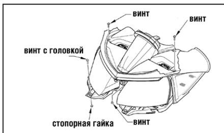
2. Удалите винт с головкой и стопорную гайку, крепящие переднюю часть передней фары к пневмоглушителю.
