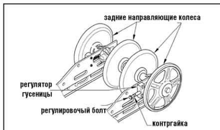
ет внутренний замыкатель выступов гусеницы к заднему направляющему колёсу, ослабьте контргайку регулировочного болта, затем вращайте регулировочный болт по часовой стрелке на несколько оборотов.
