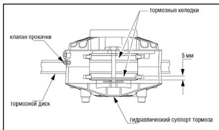
2. Снимите зажим, крепящий тормозные колодки к суппорту.
