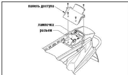
против часовой стрелки для снятия его из корпуса.
