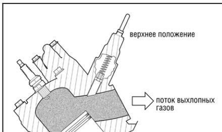
поднимаются. Это обеспечивает высокое положение выпускных портов и максимальную мощность при высоких оборотах.
