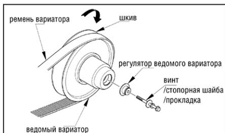
6. Закрутите винт с перевернутым регулятором в ведомый вариатор; затем затяните винт, пока тарелки вариатора не раздвинутся и это позволит снять ремень вариатора.
