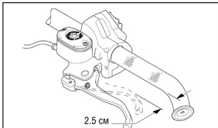
2. Проверьте уровень тормозной жидкости в резервуаре. Уровень тормозной жидкости должен быть виден в смотре-
