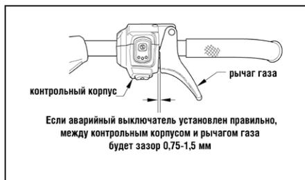
**ПРИМЕЧАНИЕ:** если зазор троса газа неправильный, поверните каждый адаптер для достижения рекомендуемого зазора. Каждый клапан плунжера должен находиться напротив края винта холостого хода.
