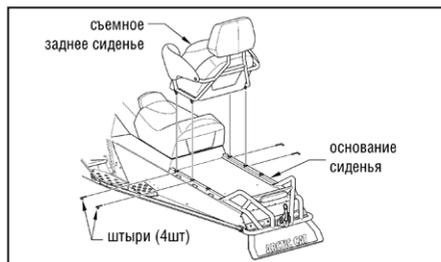
2. Надавите на защелку переднего сиденья справа и поднимите переднее сиденье; затем отсоедините разъём от задней фары.
