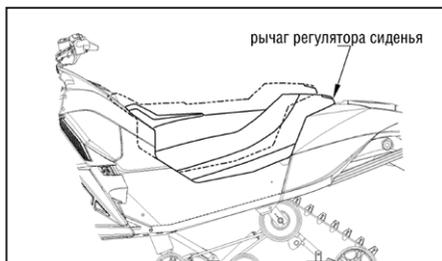
2. Поднимите заднюю часть сиденья; затем подвиньте переднюю часть сиденья вверх или вниз (всего семь возможных положений).
