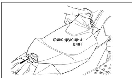
2. Надавите на левый край рычага регулятора сиденья, который находится в заднем багажном отделении; затем потяните на себя рычаг регулятора сиденья.
