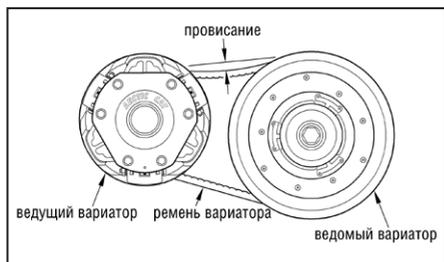
Ремень вариатора должен быть натянут между ведущим вариатором и ведомым вариатором. Для проверки провисания ремня выполните следующее.
