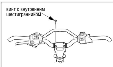
2. Отрегулируйте наклон руля; затем надежно затяните гайки крепления/винты с внутренним шестигранником. Проверьте максимальные левый и правый повороты руля.
