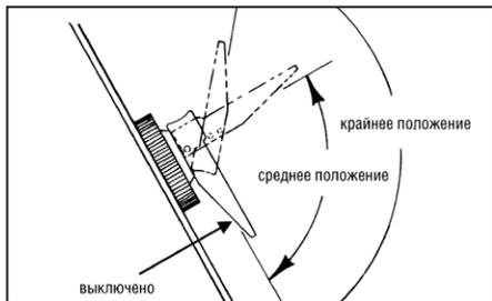
**ПРИМЕЧАНИЕ:** на карбюраторных моделях, где двигатель заводится при помощи подсоса, **НЕ НАЖИМАЙТЕ НА РЫЧАГ УПРАВЛЕНИЯ ГАЗОМ.** При нажатом рычаге газа двигатель не заведется, так как смесь бензин/воздух будет слишком бедной. Тем не менее, для запуска теплого двигателя можно немного нажать на рычаг газа.
