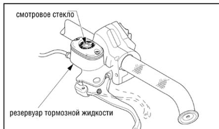
2. Если тормозная жидкость не видна в смотровое стекло, снимите крышку резервуара и долейте тормозную жидкость, рекомендуемую Arctic Cat, пока уровень жидкости не достигнет нужной отметки. Установите и закрепите крышку резервуара. Не допускайте попадания влаги в тормозную систему.
