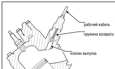
При низких оборотах выпускные клапаны удерживаются в нижнем положении пружинами возврата.
