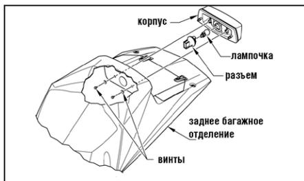
2. На моделях Bearcat 570/T-Series/TZ1 снимите винты, крепящие панель доступа к задней фаре.
