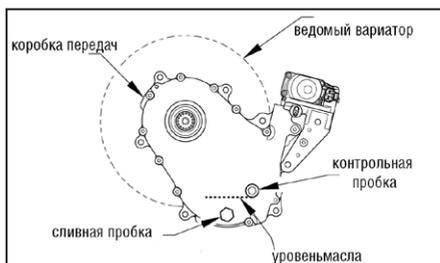
**ПРИМЕЧАНИЕ:** для ускорения слива масла рекомендуется использовать адаптер Gear Case Drain Fitting (№ 0644-508) и шланг длиной 10см.
