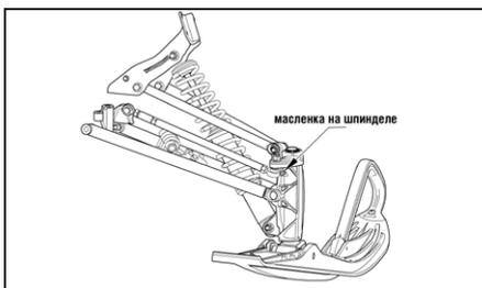
На моделях Crossfire/M-Series добавьте смазку в масленку А-образного рычага (расположена с каждой стороны снегохода прямо под внутренним винтом, крепящую верхнюю часть А-образного рычага к ходовой части). Пока смазка не начнет вылезать из нижней части рычага. Удалите излишек смазки с поверхности рычага.
