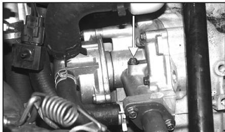
**ПРИМЕЧАНИЕ:** Когда вы перестанете слышать шум воздуха, выходящего из выпускного дросселя масляного насоса, затяните болт с усилием 1-1,05 кг/м.
