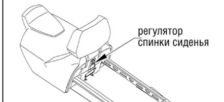
Для изменения высоты спинки сиденья опустите регулятор вниз, отрегулируйте спинку и поднимите регулятор для фиксации спинки в новом положении.
