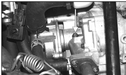
**ПРИМЕЧАНИЕ:** Когда вы перестанете слышать шум воздуха, выходящего из выпускного дросселя масляного насоса, затяните болт с усилием 1,05 кг/м.
