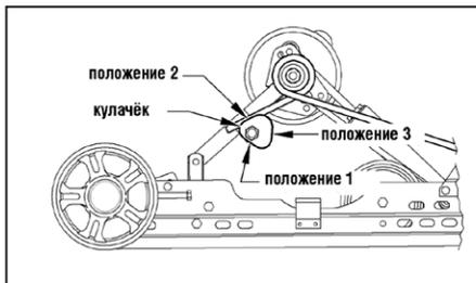
Для того, чтобы повернуть кулачок используйте ключ для свечей зажигания из набора инструментов. Поворачивайте ключ, пока кулачок не достигнет желаемого положения. Проведите соответствующие настройки кулачка с другой стороны снегохода.
