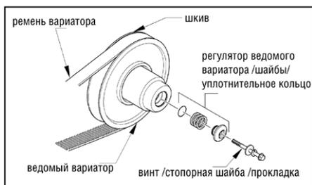
5. Выкрутите винт с регулятора, разверните его и вставьте в него винт.
