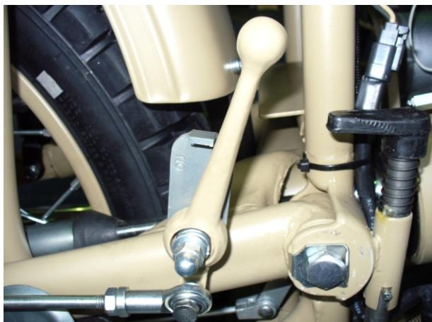
**Привод на коляску отключен
