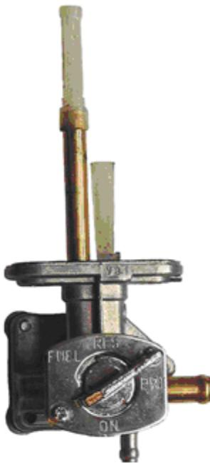
1. Если мотоцикл простоял долгое время без работы, или после полного опустошения бака или карбюраторов (топливо не было залито, испарение топлива, замена частей), то поставьте бензокраник в положение **PRI**. Это наполнит поплавковые камеры карбюраторов и подготовит двигатель к запуску.
