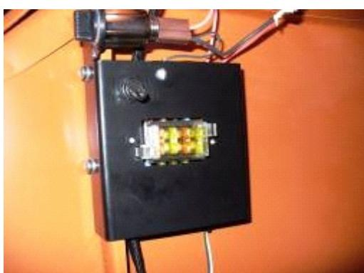
Блок предохранителей в коляске мотоцикла
