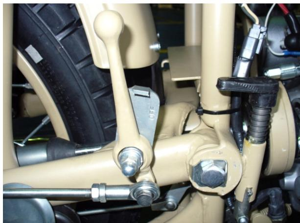
**Привод на коляску включен
