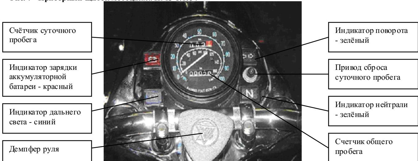
Рис. 8 Приборный щиток мотоцикла ИМЗ-8.103 6 (ИМЗ-8.1236)
