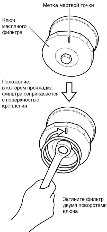
10. Отметьте положение мертвой точки на ключе фильтра или на фильтре. Используйте ключ фильтра, чтобы затянуть фильтр на 2 поворота.
