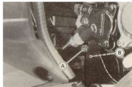
А. Воздушный болт В. Водяной насос
