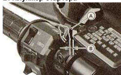
A. Рычаг заслонки B. 2-3 мм
