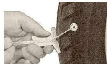
А. Прибор замера глубины протектора шины
