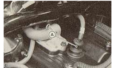
A. Колпачок свечи зажигания
