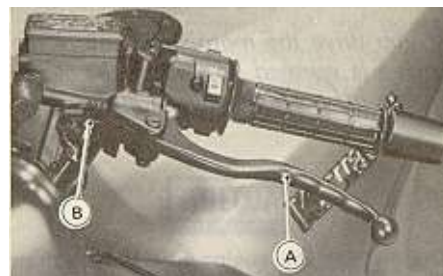
А. Рычаг управления сцеплением В. Блокировка стартера
