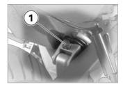
• Отрегулируйте амортизатор регулировочным винтом **1**.
