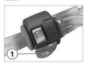
Нажмите кнопку выключателя левых указателей поворота 1 для включения парковочного освещения.
