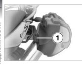
Если кофр укреплен непрочно или устанавливается на место только с большим трудом, необходимо отрегулировать расстояние между верхним и нижним креплением. Нижнее крепление 1 можно регулировать по высоте.
