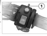
Экстренный выключатель зажигания
