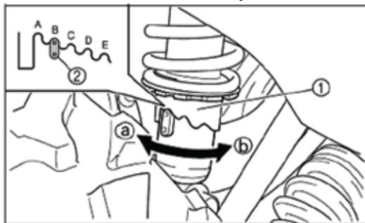
1. Кольцо регулировки жесткости пружины.
