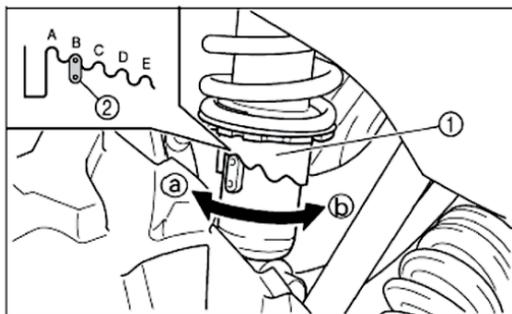
1. Кольцо регулировки жесткости пружины.
