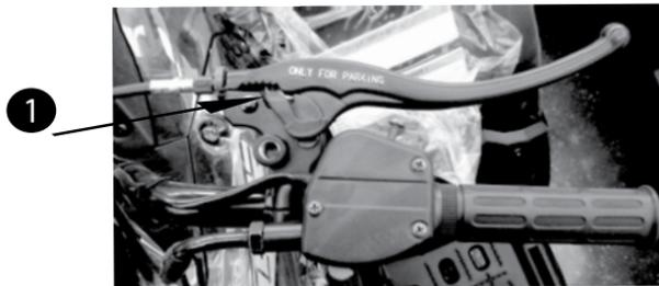
Используйте стояночный тормоз при запуске двигателя или при остановке мотовездехода на стоянке, особенно на склоне.
