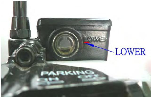
\* Доливка тормозной жидкости
