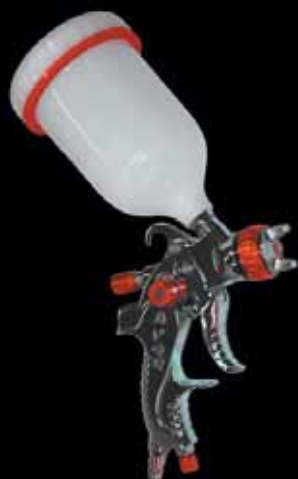
Краскопульт пневматический (1,4 мм, верхний бачок 600мл) H.V.L.P. ПРОФИ Артикул 770-834
