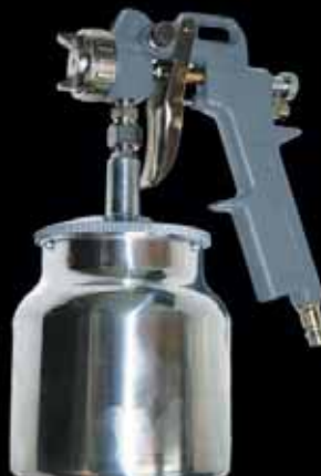
Краскопульт пневматический (1,5мм, нижний бачок 750 мл) Артикул 770-827
