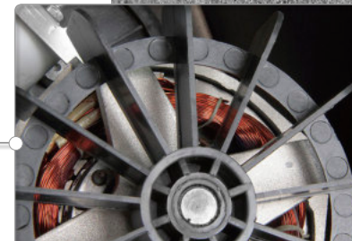
АСИНХРОННЫЙ ЭЛЕКТРОДВИГАТЕЛЬ С МЕДНОЙ ОБМОТКОЙ
