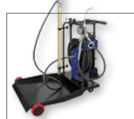
Тележка используется как установка раздачи с пневматическим насосом и шлангом
