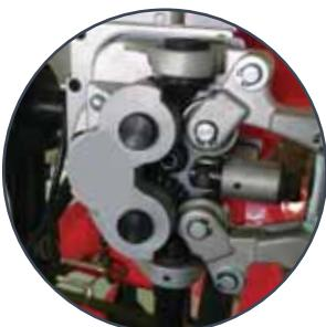
Пространственная регулировка положения горелки по 4 осям
