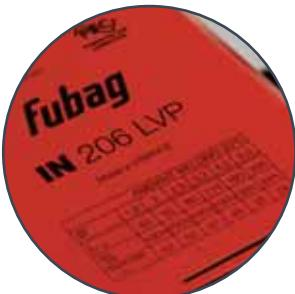
Таблица технического подбора – на корпусе аппарата
