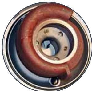
Рабочее колесо и улита насоса из высокотехнологичных материалов
