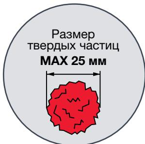
Возможность качать воду с частицами до 25 мм
