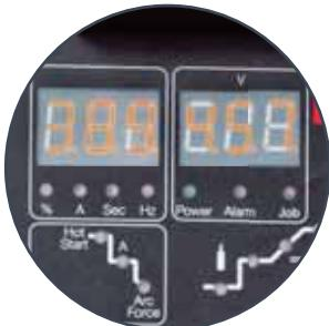
Цифровая индикация параметров сварки
