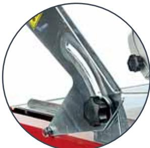
Угол поворота станины 0 – 45° для резки фасок. Возможность реза на заданную глубину
