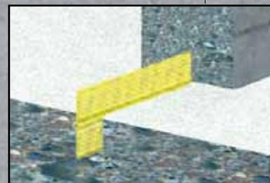
Гидрошпонки **Sika® Waterbar** или **Tricosal®** устанавливаются в будущий шов и заливаются бетоном, создавая препятствие лабиринтного типа на пути проникновения воды. Они выпускаются различных типоразмеров для различных условий эксплуатации и давлений воды.
