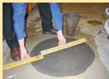
Увеличение подвижности бетонной смеси при добавлении суперпластификатора серии Sika® ViscoCrete® 5 600
