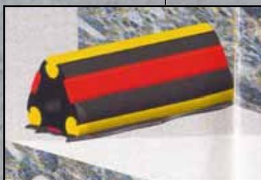
Система состоит из инъекционных шлангов **SikaFuko®** разного типа, позволяющих при возникновении протечек закачать через них инъекционный раствор. Инъекционный материал проникает в тело бетона, уплотняет шов и герметизирует все полости. Технология подразумевает многократное инъектирование. Также возможно применение инъекционного шланга с набухающими вставками.
