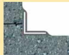
Гидроизоляционная лента **Sikadur® Combiflex® SG**
