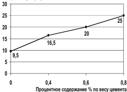
Таблица 2. Осадка конуса образцового бетона C20/25, CEM II/B 32,5 (320 кг/м<sup>3</sup>), В/Ц отношение = 0,59.
